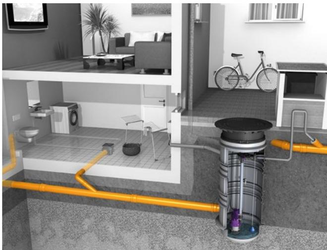
Le poste de relevage *Aqualift F* est destiné à l'évacuation des eaux usées contenant des matières fécales sous le niveau des eaux les plus hautes. La cuve à enterrer d'un diamètre de 600 mm comprend la pompe STZ 1000 pour eaux grises et eaux vannes et résiste à une installation en nappe phréatique jusqu'à 2000 mm de profondeur.
