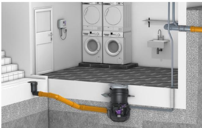
Le poste de relevage *Aqualift S Compact* assure une évacuation efficace des eaux grises par la canalisation de refoulement vers le réseau. Le poste de relevage est disponible avec une commande par flotteur ou une régulation par sonde. La rehausse réglable en hauteur, en rotation et en inclinaison permet une parfaite adaptation lors de l'installation.
