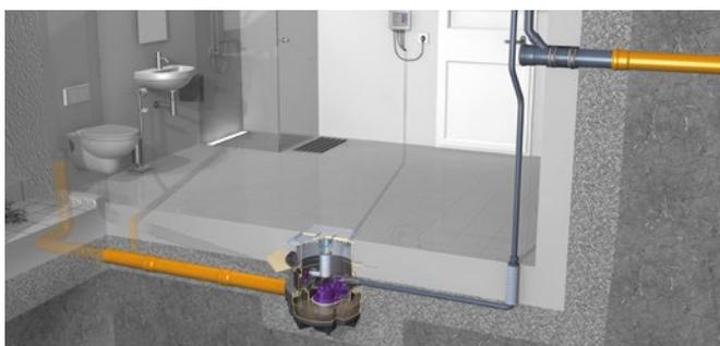
Le poste de relevage *Aqualift F Compact* se charge du relevage complet du sous-sol. Ils évacuent les eaux usées en toute sécurité et automatiquement dans la canalisation au-dessus du niveau des plus hautes eaux. Même en cas de rupture de tuyau ou d'inondation – grâce au couvercle de finition avec siphon intégré. Ses dimensions compactes facilitent son installation ou sa pose hors sol.
