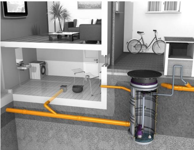
Le poste de relevage *Aqualift S* s'emploie pour l'évacuation des eaux usées sans matières fécales sous le niveau des eaux les plus hautes, pour la protection anti-retour des séparateurs. Il comprend une cuve d'un Ø de 600 et une pompe intégrée pour eaux usées et eaux pluviales ; il se prête à une installation en nappe phréatique jusqu'à 2000 mm de profondeur.
