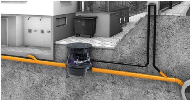
Avec *Ecolift XL*, nous proposons un poste de relevage hybride spécialement conçu pour un emploi dans des bâtiments à usage commercial et industriel ou des immeubles collectifs où une évacuation gravitaire existe. En mode de fonctionnement normal, *Ecolift XL* évacue les eaux usées par gravité et n'enclenche les pompes qu'en cas de reflux – avec une puissance de 1,5 à 4,5 kilowatts.
